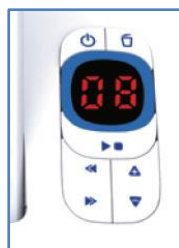
Touche d'accès et compteur de messages sur la base
