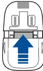
3. Legen Sie die 4 Mikrofone auf die Basisstation und lassen Sie sie vor der ersten Benutzung 8 Stunden lang laden. Wenn die LED auf dem Mikro rot leuchtet, liegt es richtig auf.
